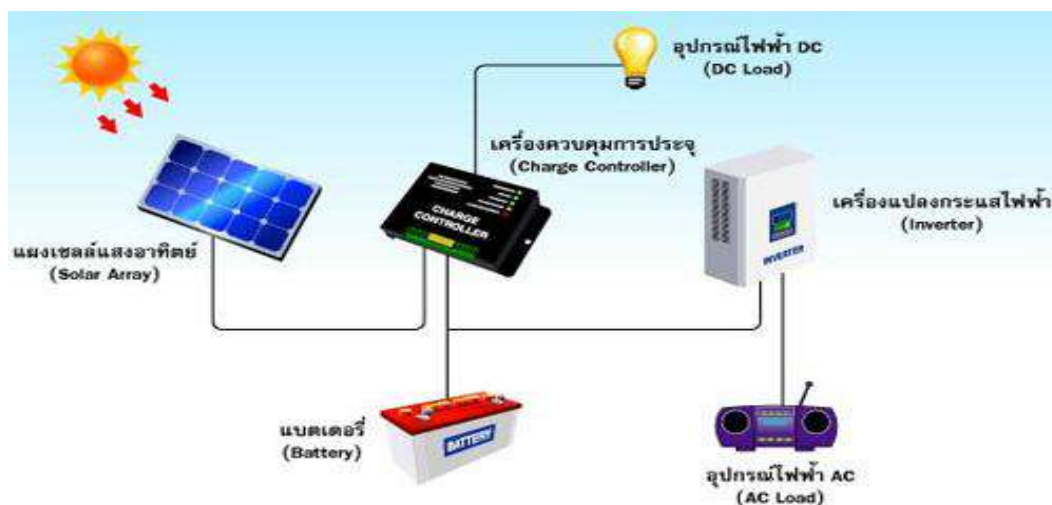
ภาพที่ 9 โครงสร้างระบบผลิตไฟฟ้าจากเซลล์แสงอาทิตย์
