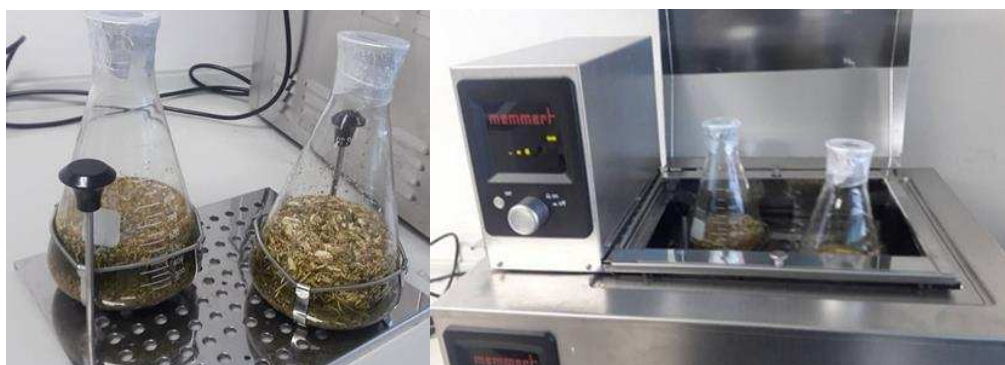
ภาพที่ 7 การหมักผักเสี้ยนผีโดยใช้เครื่องเขย่าสาร (Shaker)
