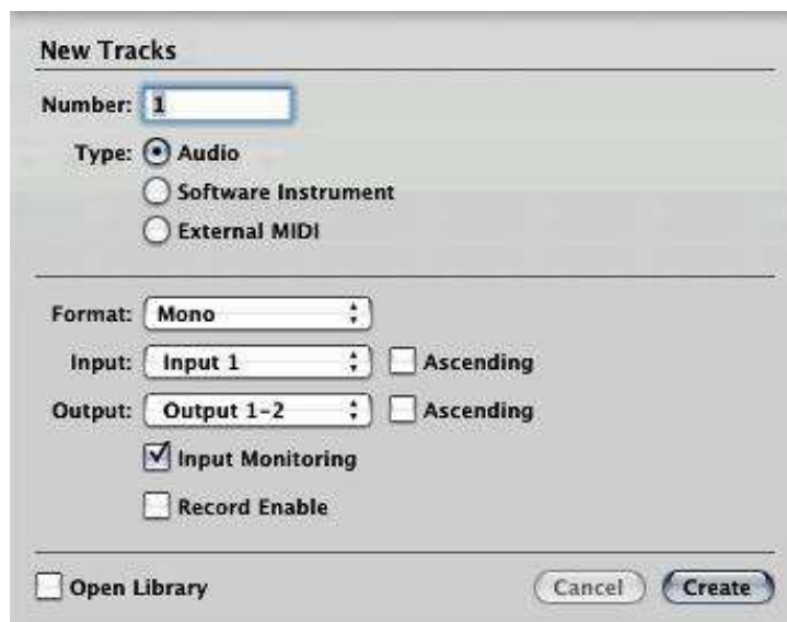
ภาพที่ 9 Input Monitoring เลือกเพื่อใช้ฟังเสียงที่กำลังจะบันทึก
